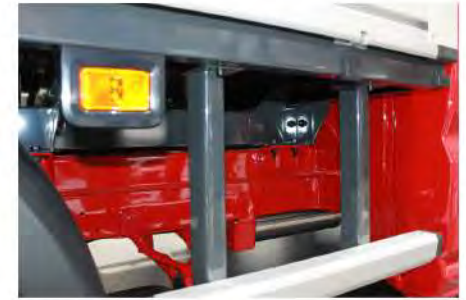
Detailbild der seitlichen Markierungsleuchte am Unterfahrschutz des Pritschenwagen montiert.
