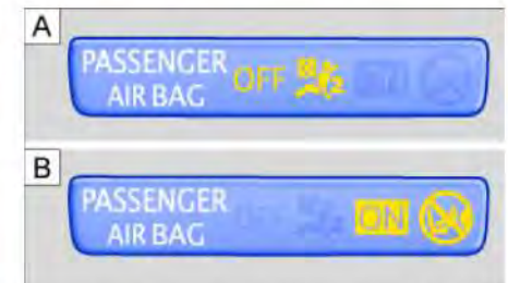
Anzeigeschema bei deaktiviertem (A) und aktiviertem (B) Beifahrer-Airbag.
