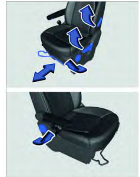
Verstellmöglichkeiten des Komfortsitzes.
