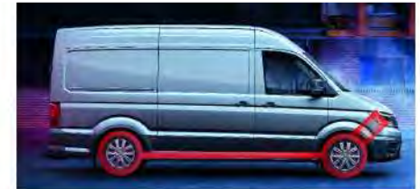
Schematische Darstellung des Allradantriebs 4MOTION.
