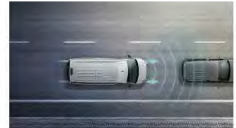
Schematische Darstellung der funktionsweise der automatischen Distanzregelung ACC.
