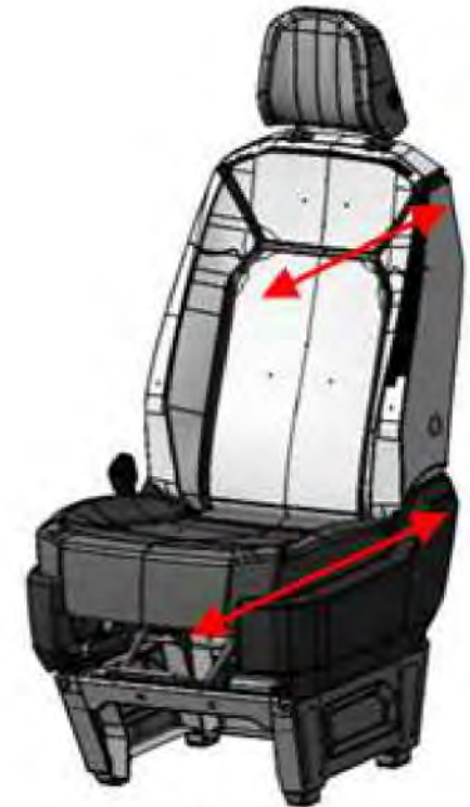
Sitzverstellmöglichkeiten beim Standardsitz.
