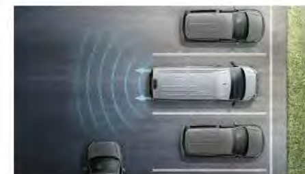
Schematische Darstellung Ausparkassistent.
