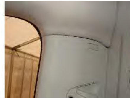
Position des Kopfairbags (Beifahrerseite).
