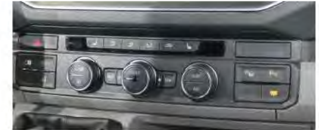
Regeleinheit für die Klimaanlage "Climatronic".
