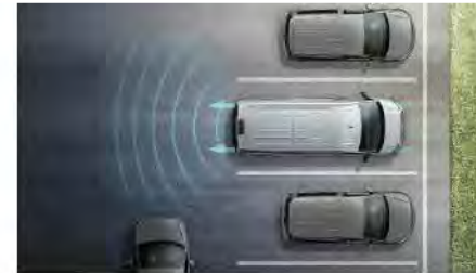
Schematische Darstellung Ausparkassistent.
