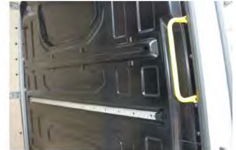
Haltegriff an der Trennwand
