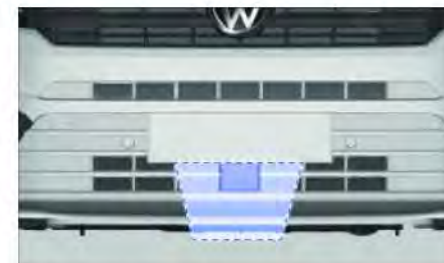
Platzierung des Radarsensors im Kühlergrill.
