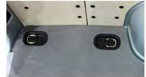
Beispiel Verzurrösen im hinteren Laderaum des Kastenwagens.
