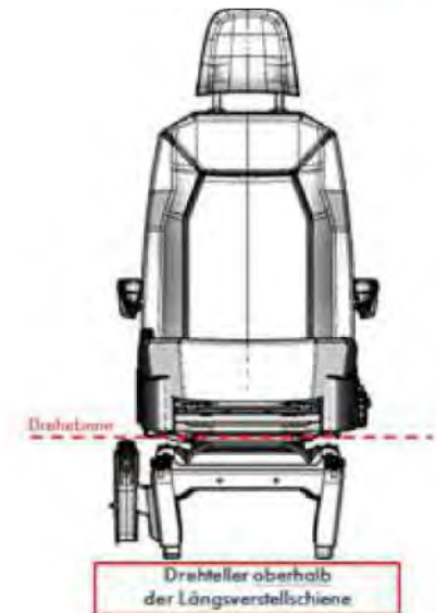
Technische Darstellung der Drehebene (am Beispiel des linken Sitzes).
