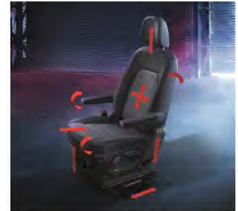
Einstellmöglichkeiten des Schwingsitz "ergoComfort".
