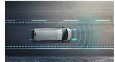
Schematische Darstellung "Lane Assist".
