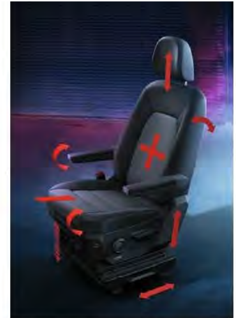
Einstellmöglichkeiten des Schwingsitz "ergoActive".
