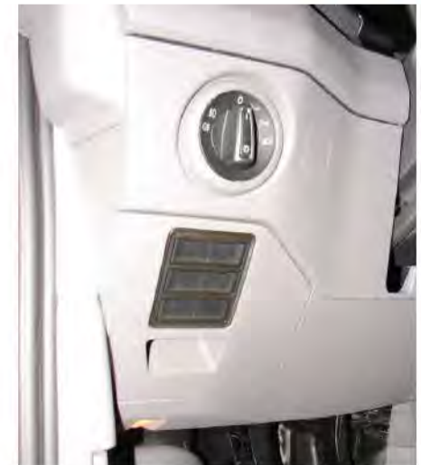
Schaltereinheit unterhalb Lichtschalter
