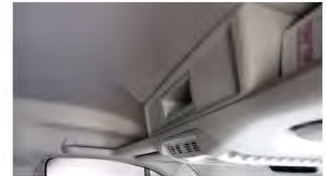
Ablagen in der Dachgalerie mit einem 1-DIN Schacht.
