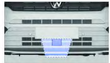
Platzierung des Radarsensors im Kühlergrill.
