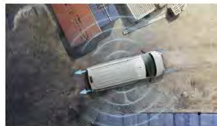
Schematische Darstellung Flankenschutz.
