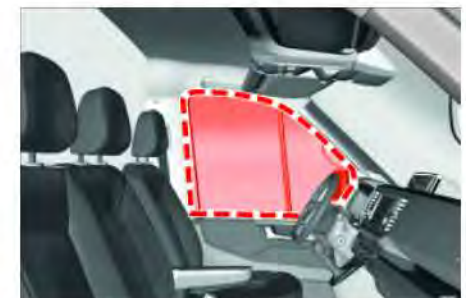
Schematische Darstellung des geöffneten Kopfairbags.
