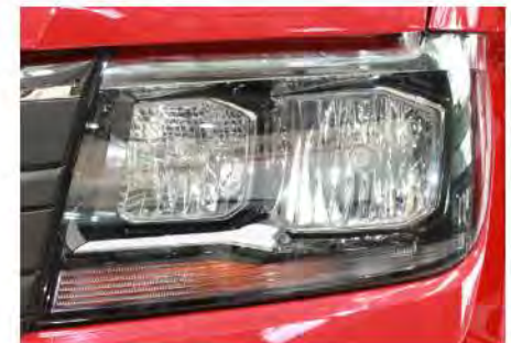
Tagfahrlicht in Halogen-Doppelscheinwerfer, LED-Leuchtmittel rechts oben.
