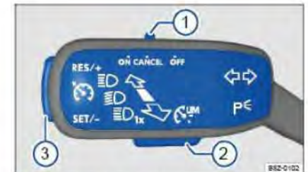
Abb. 97 An der Lenksäule links: Schalter und Tasten zum Bedienen des Geschwindigkeitsbegrenzers.
