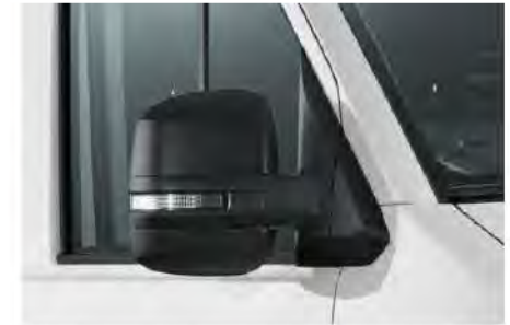
Außenspiegel rechts, mit integrierter LED-Blinkleuchte.
