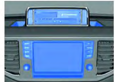
Einbauort des digitalen Tachographs in der 1-DIN Aufsatzkonsole.
