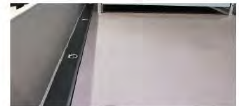
Verzurrösen auf dem Pritschenrahmen des Pritschenwagens.
