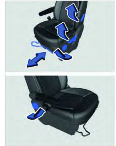
Verstellmöglichkeiten des Komfortsitzes.
