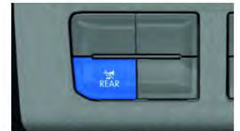
Taste zum Deaktivieren der akustischen Warnanlage.
