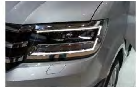
LED-Tagfahrlicht im LED-Hauptscheinwerfer.
