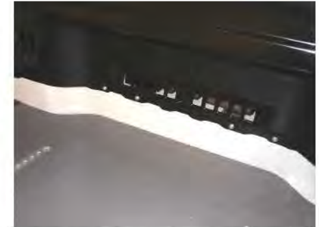
Luftausströmer in den Laderaum.
