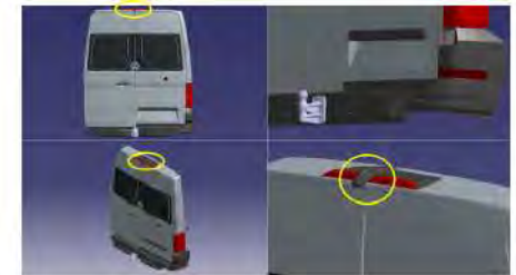
Verbauort der Rückfahrkamera.
