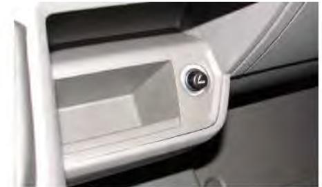
12-V-Steckdose in der Mittelkonsole (hier mit Zigarettenanzünder).
